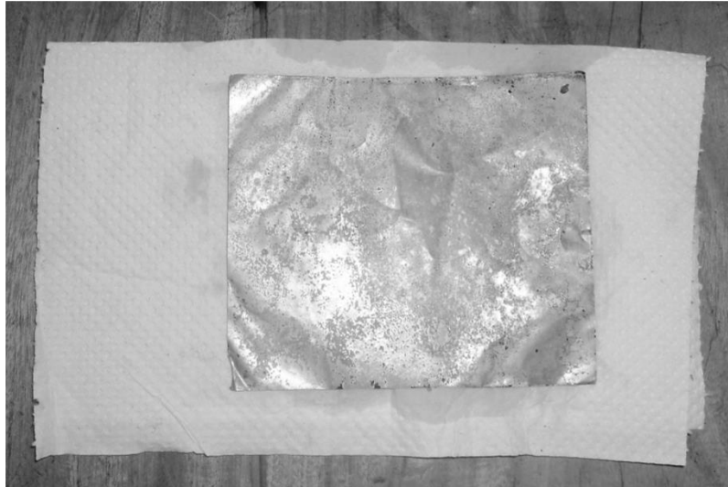
Figura 45. Aplicación de ácido nítrico al 15 por ciento, sobre la lámina previamente calentada
