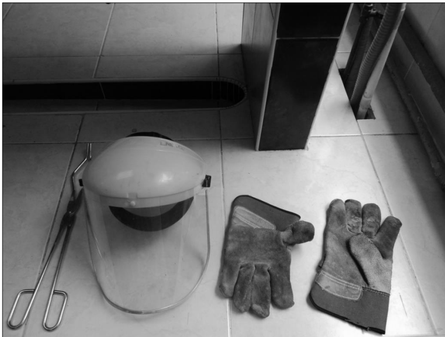
Figura 29. Equipo de protección personal (guantes de asbesto, careta protectora, pinzas para crisoles)
