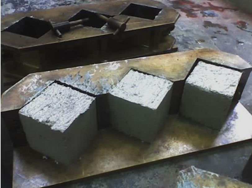
Figura 26 Desencofrado de cubos
