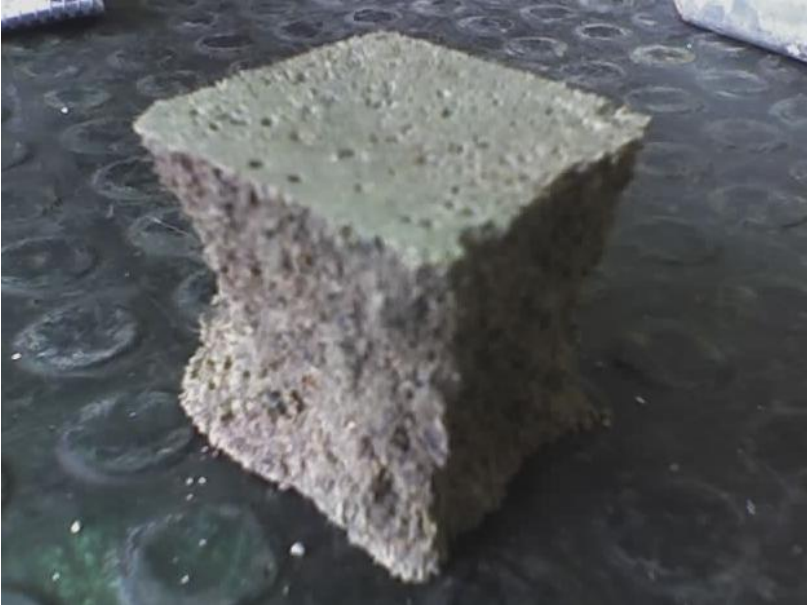
Figura 32 Falla de reloj de arena
