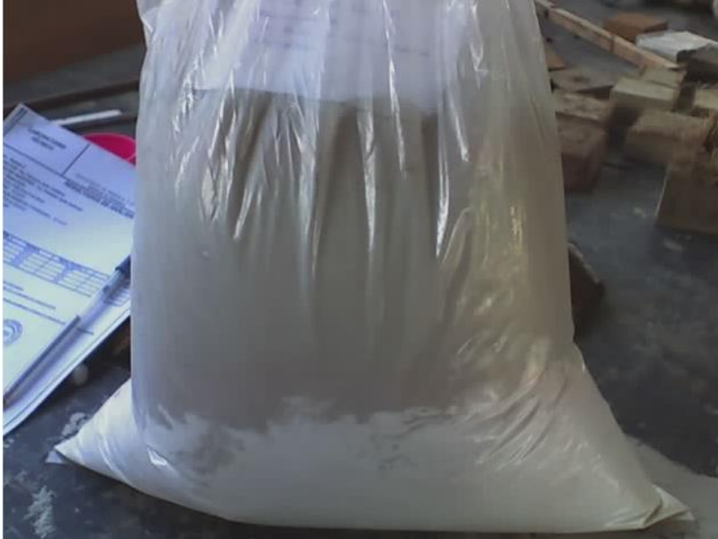
Figura 18 Mezcla de 34% de cal y 66% de material
