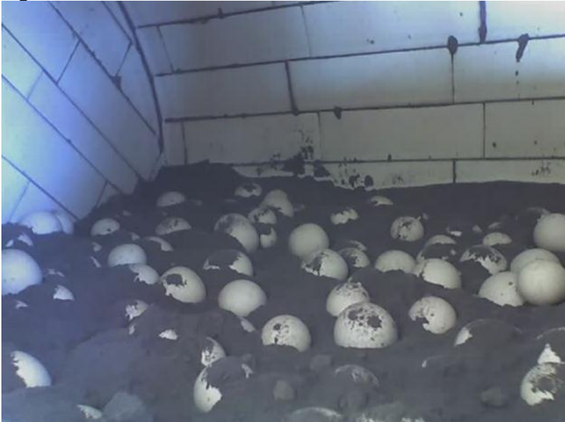
Figura 14 Vista interior de molino de bolas
