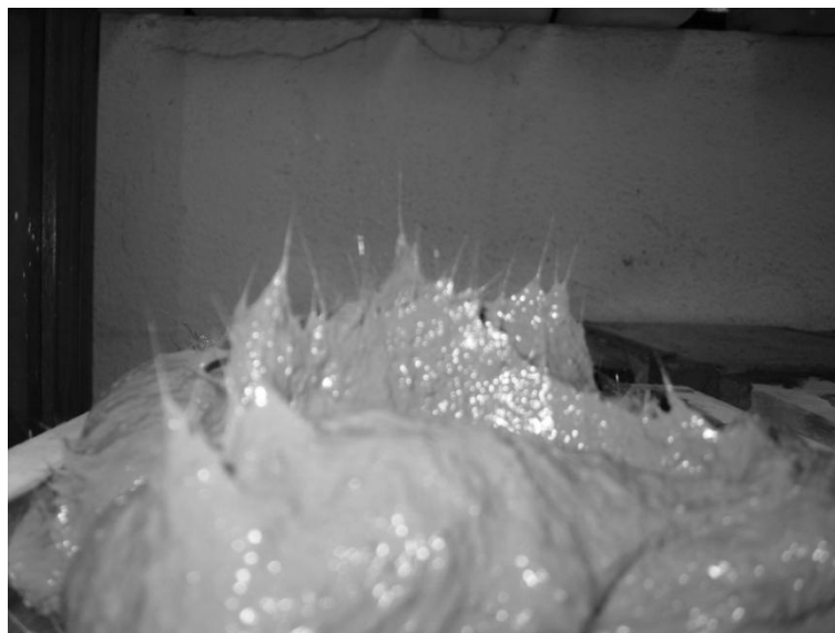
Figura 21. Detalle de mezcla con 1% fibra.
