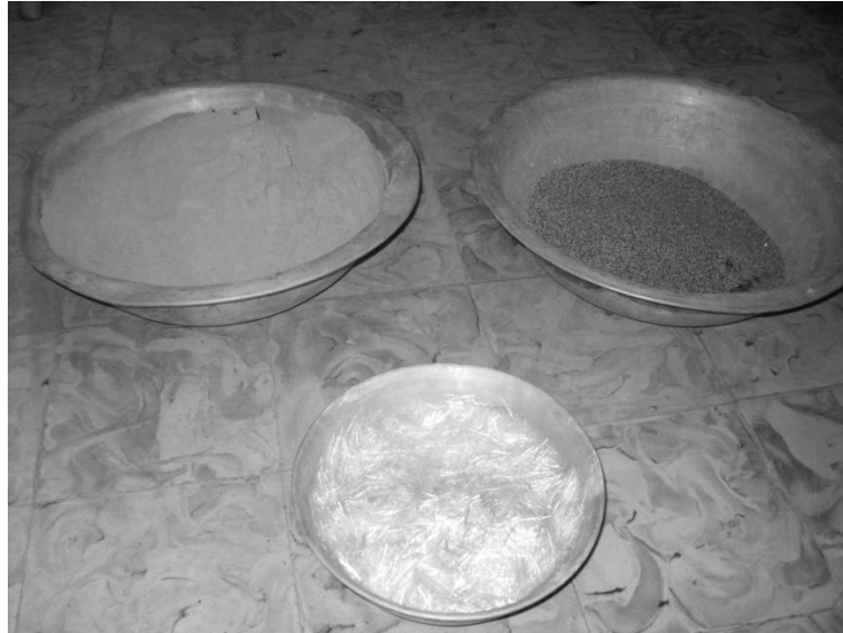
Figura 9. Ilustración de proporciones reales pesadas para las mezclas. Arriba cemento y arena; abajo fibra al 2.5%.
