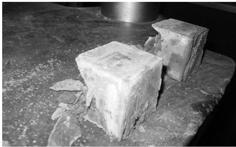
Figura 29. Detalle de cubos fallados a compresión.
