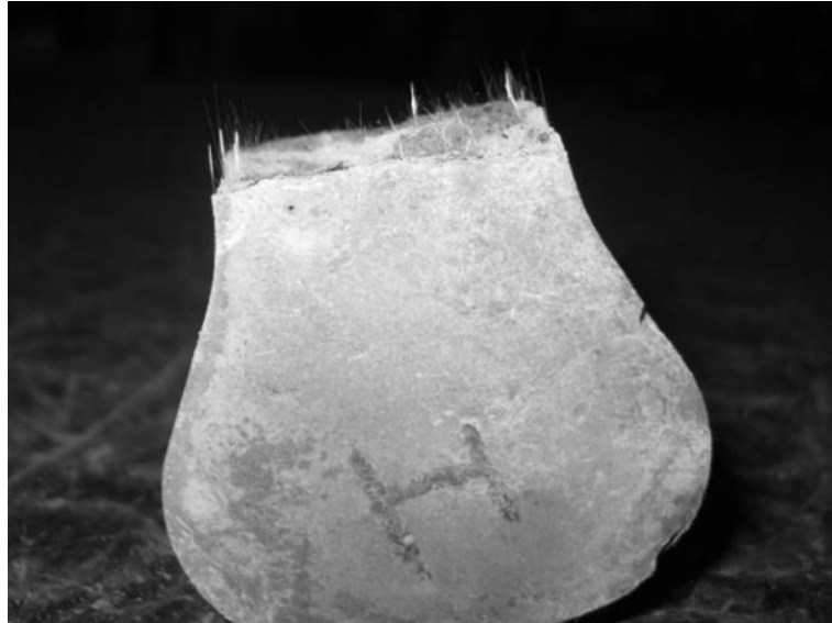
Figura 45. Detalle de las fibras en briqueta con 0.5% fibra.
