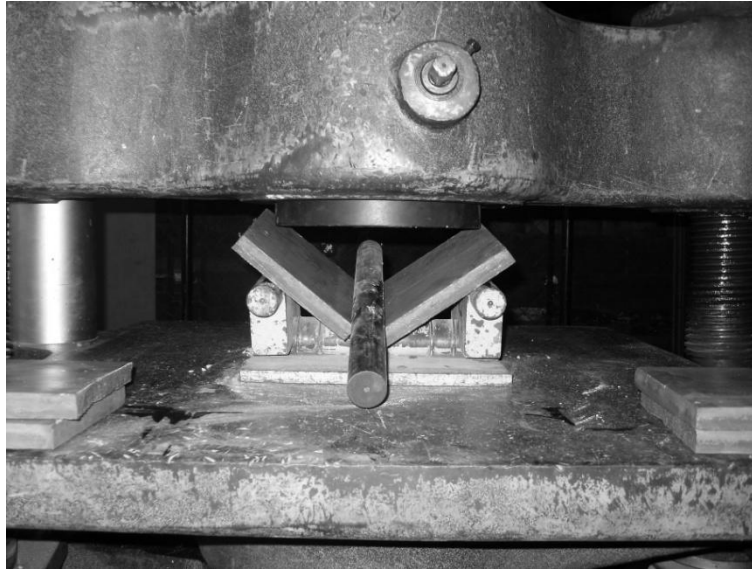
Figura 34. Falla típica de las planchas a flexión.
