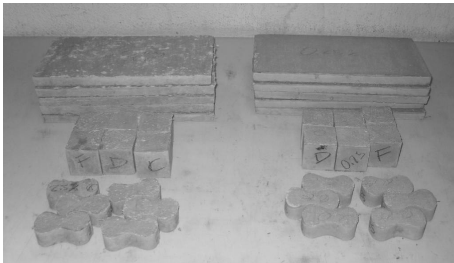
Figura 13. Probetas de ensayo desencofradas e identificadas.
