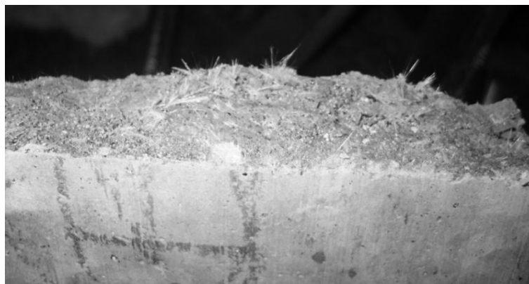
Figura 48. Detalle de las fibras en plancha con 2.5% fibras.
