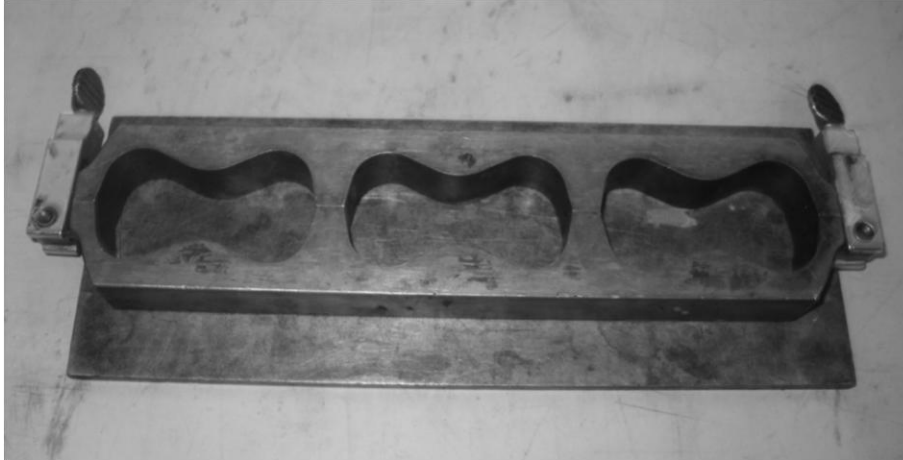
Figura 14. Moldes especiales para briquetas.
