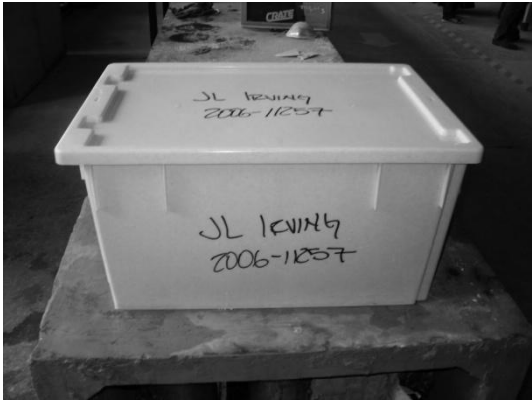
Figura 24. Recipiente de curado para las planchas.
