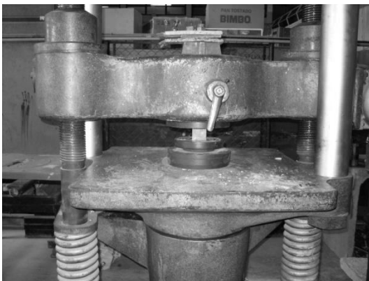
Figura 28. Detalle de la colocación de los cubos en la máquina de ensayo.
