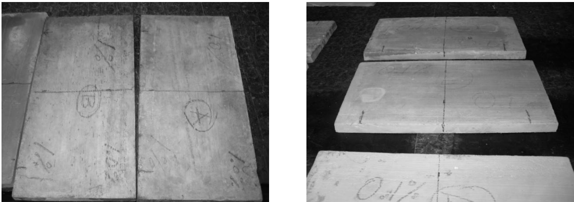
Figura 30. Identificación de los puntos de carga y apoyo en las planchas.
