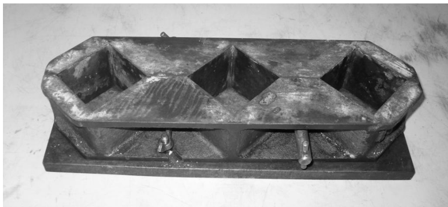
Figura 16. Moldes especiales para cubos.
