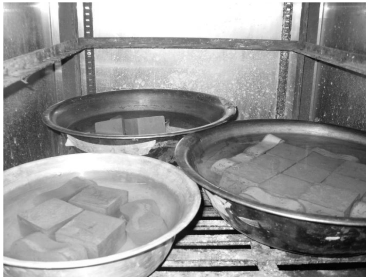
Figura 12. Cubos y briquetas dentro de la cámara de humedad.
