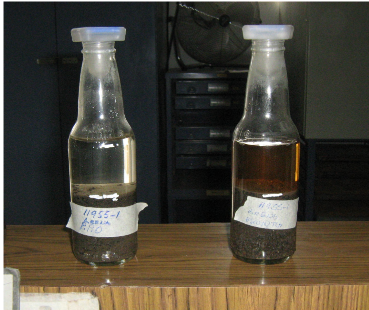
Figura 32. Matraces con muestras de agregado fino, ensayo de densidades relativas y porcentaje de absorción, ASTM C 128
