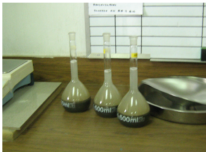
Figura 32. Matraces con muestras de agregado fino, ensayo de densidades relativas y porcentaje de absorción, ASTM C 128
