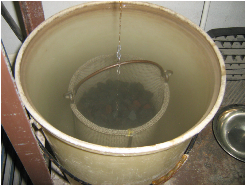
Figura 33. Proceso de ensayo para determinar las masas unitarias del agregado grueso de la Planta Escuintla
