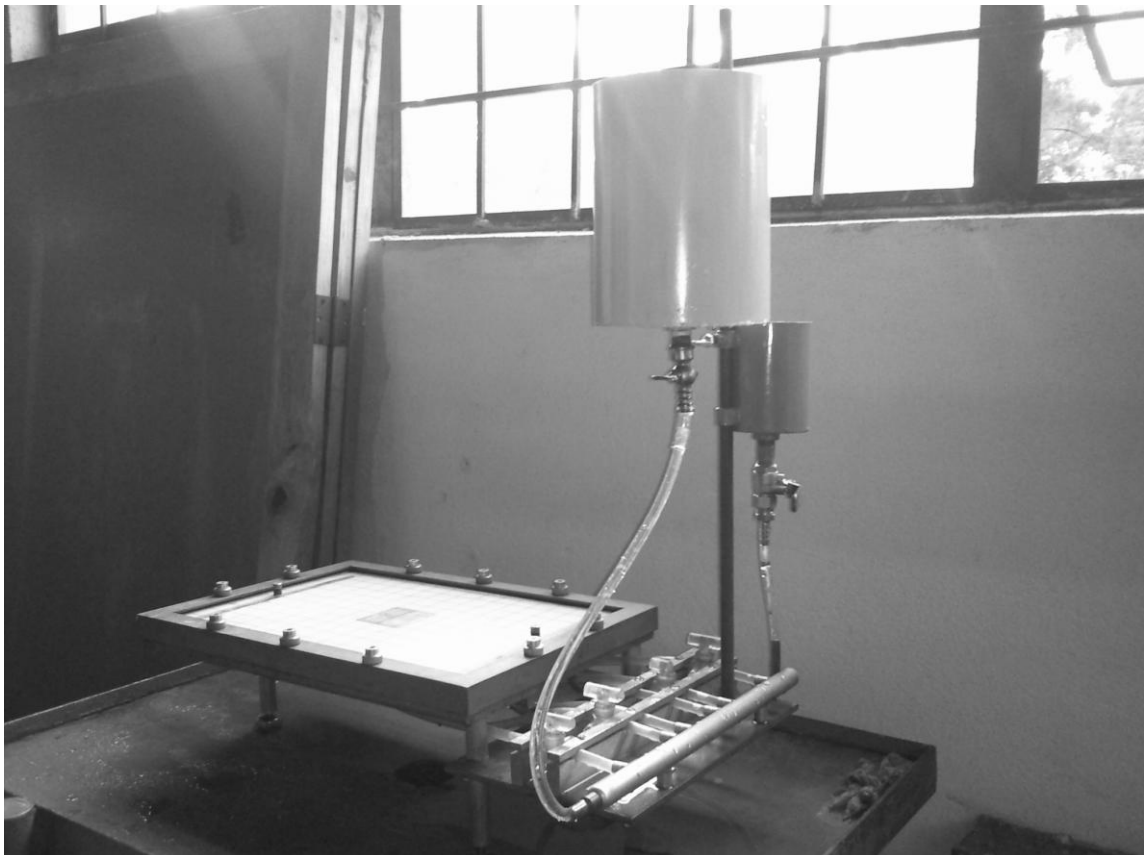
Figura 40. Equipo para estudiar el comportamiento de líneas de corriente a través de una figura
