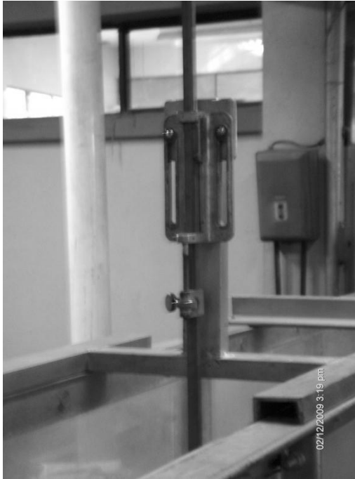
Figura 44. Detalle del medidor de aguja (limnimetro)
