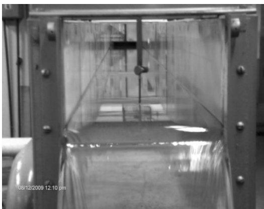
Figura 45. Medición de tirantes
