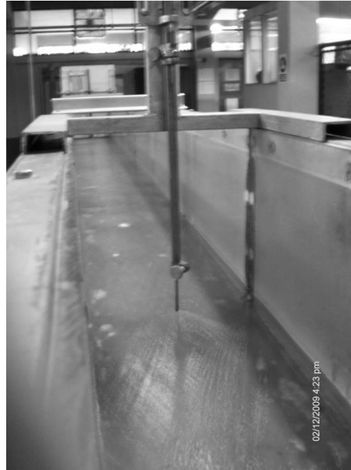
Figura 44. Detalle del medidor de aguja (limnimetro)
