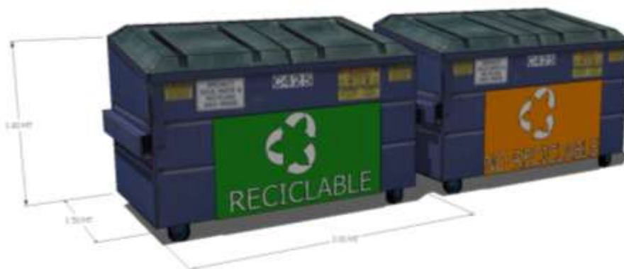
Figura 34. Contenedores para los puntos de acopio provisional
