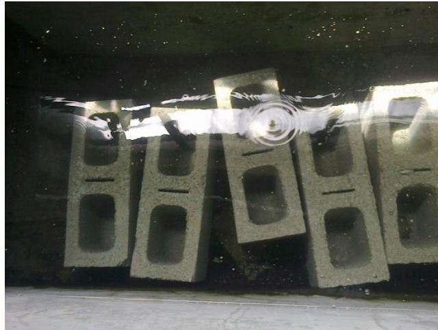
Figura 29. Blocks ecológicos sumergidos en la pila
