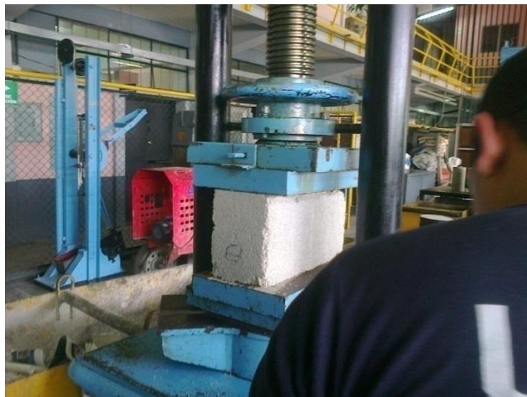
Figura 24. Ensayo de compresión block Núm. 8
