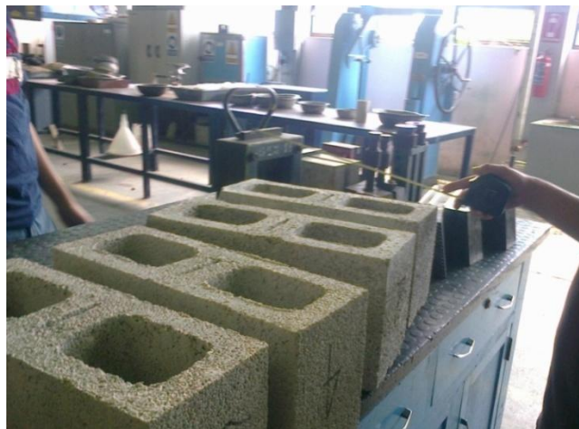
Figura 28. Medición de las dimensiones de cada block ecológico
