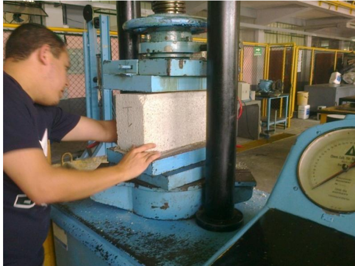
Figura 23. Ensayo de compresión de block Núm. 1
