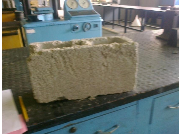
Figura 20. Block Núm. 7 desportillado
