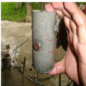
Figura 49. El núcleo de concreto limpio y sin lastimaduras.
