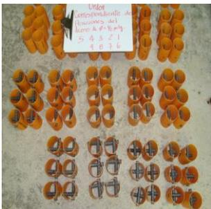
Figura 35. Conjunto de moldes con acero de  $\frac{1}{2}$  pulgada insertado, formando las nueve posiciones estudiadas.
