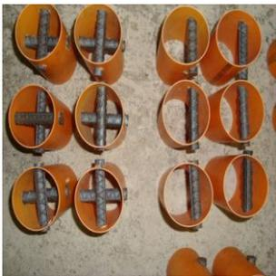
Figura 34. Vista de los moldes con las varillas de acero insertadas según la posición determinada.
