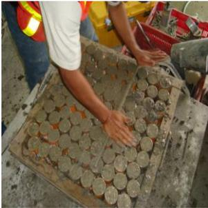
Figura 44. Con una varilla se realiza el enrazado de los moldes.
