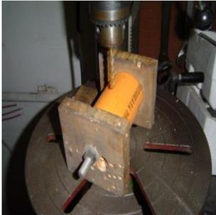
Figura 33. Barrenado de orificios en los moldes cilíndricos, con taladro vertical, para la inserción de las varillas de acero.
