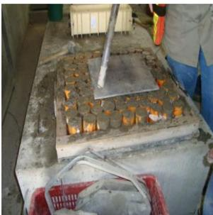
Figura 46. Se aplicó otro método, con la ayuda de una placa metálica para lograr vibración más uniforme.
