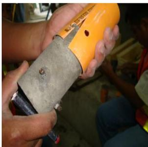
Figura 48. El molde de PVC se extrae fácilmente debido a la poca adherencia del concreto al material.
