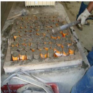
Figura 45. Con la ayuda de un vibrador se logra una mayor compactación del concreto para evitar cavidades por aire atrapado dentro de la mezcla.
