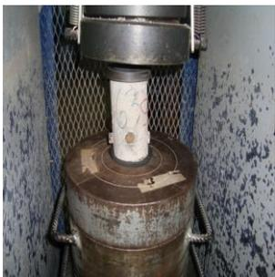
Figura 53. Pistón superior de la máquina de ensayo a compresión, bajando para hacer contacto con el núcleo de concreto.
