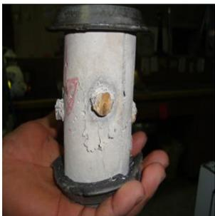
Figura 54. Núcleo de concreto ensayado, pueden observarse las fallas resultantes.
