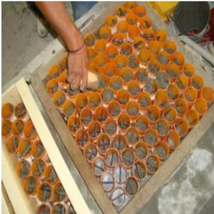
Figura 43. Vertiendo la mezcla de concreto dentro de los moldes.
