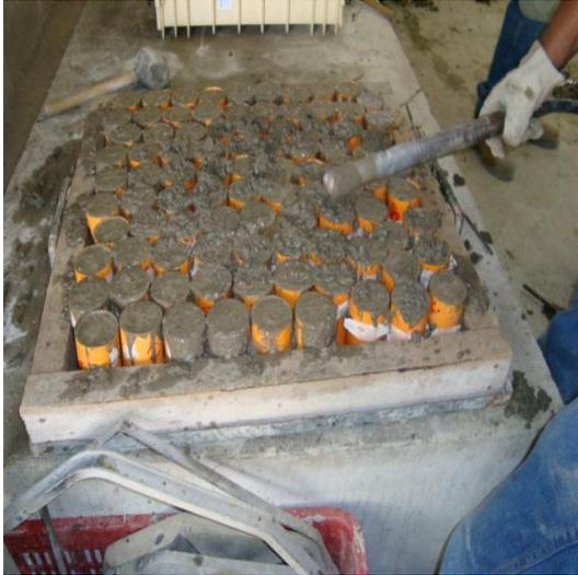
Figura 23. Etapa de desencofrado del núcleo de concreto, ya solidificado.
