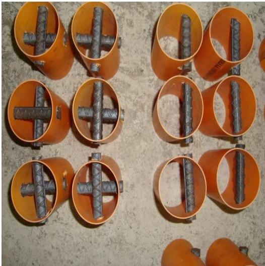
Figura 18. En la figura se presentan las nueve posiciones trabajadas con acero incrustado de ½ pulgada, además de los seis moldes patrón
