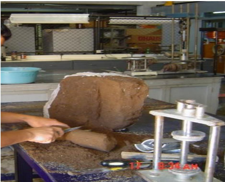
Figura 9. Otros de los ensayos por realizarse al suelo son: resistencia a compresión confinada por medio del ensayo triaxial.
