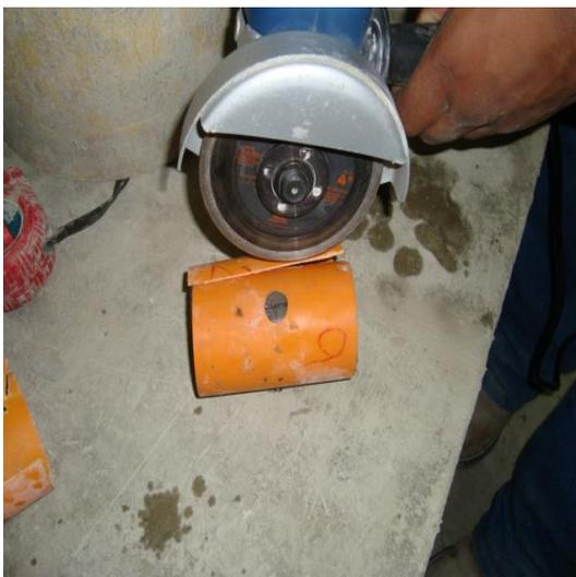
Figura 24. Núcleo de concreto ya listo para la etapa de curado en agua para lograr diferentes edades de curado a 20, 28 y 56 días.
