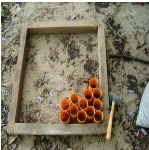
Figura 37. Colocación de los moldes dentro del marco.
