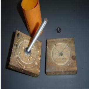
Figura 32. Piezas diseñadas para sujetar los moldes de PVC.
