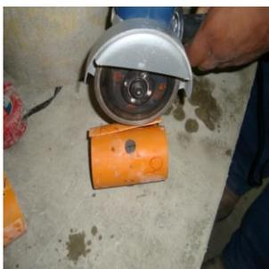
Figura 47. Corte del molde con la ayuda de un disco de corte con punta de diamante.
