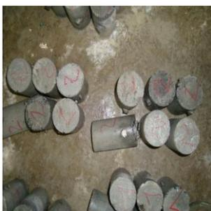
Figura 50. Núcleos de concreto listos para el curado en agua.
