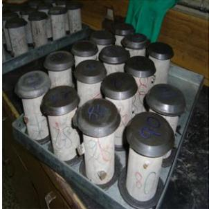
Figura 51. Núcleos de concreto ya cabeceados con azufre para poder nivelar sus extremos.
