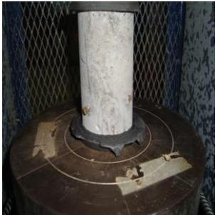
Figura 52. Núcleo de concreto nivelado dentro de la máquina de ensayo a compresión.
