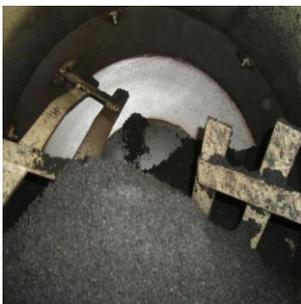
Figura 41. Mezcladora conteniendo los agregados fino, grueso y cemento UGC.
