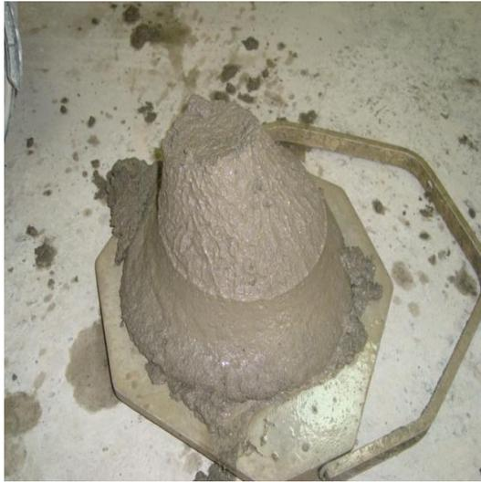
Figura 21. Medición de la diferencia de la altura inicial del molde con la altura final de la mezcla de concreto habiendo retirado el molde, según norma ASTM C – 143.
