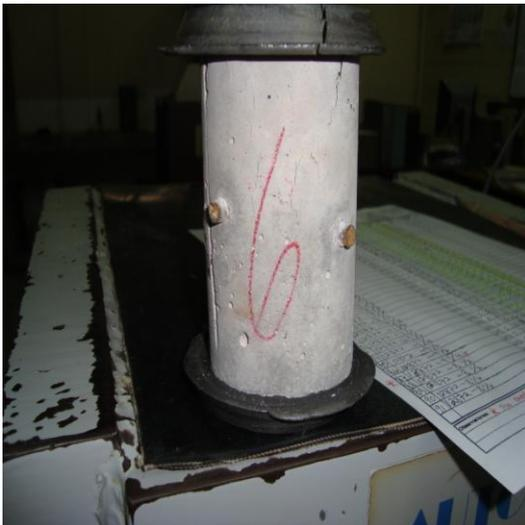
Figura 28. La figura muestra los cuatro núcleos patrón ya ensayados, las fallas están resaltadas en con tiza color lila.
