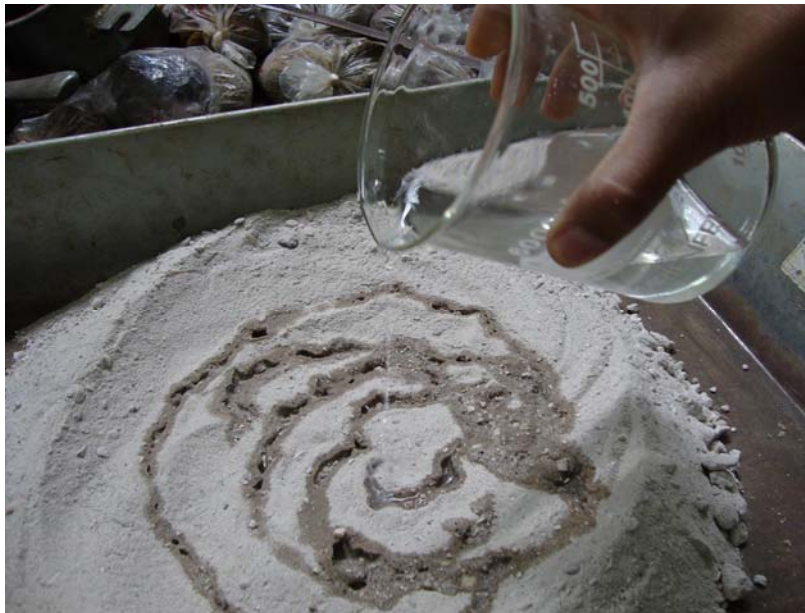
Figura 9. Aplicación de salmuera en laboratorio
