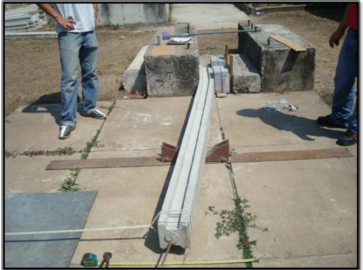
Figura 24. Ensayo a flexión poste pretensado
