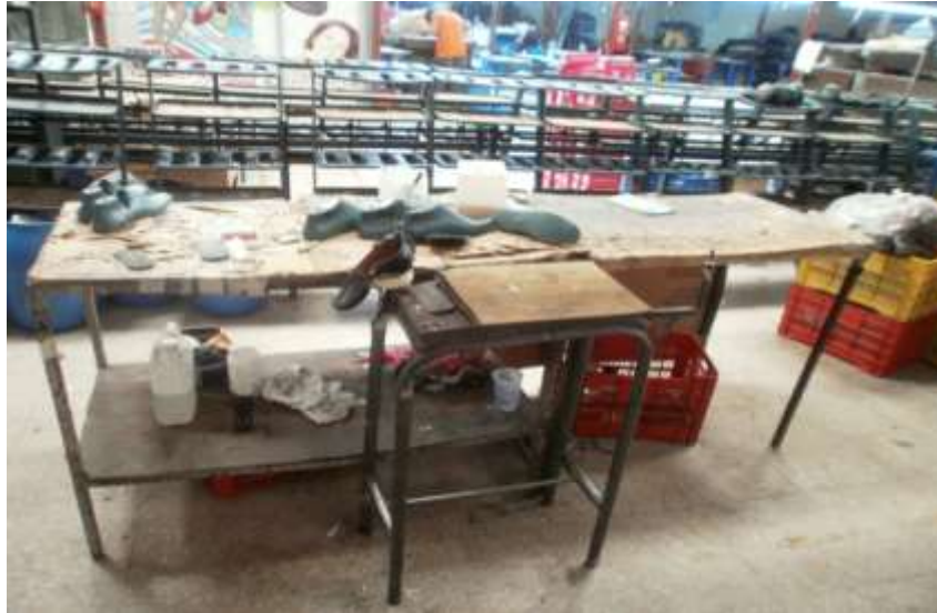
Figura 22. Puesta de hormas y embauche
