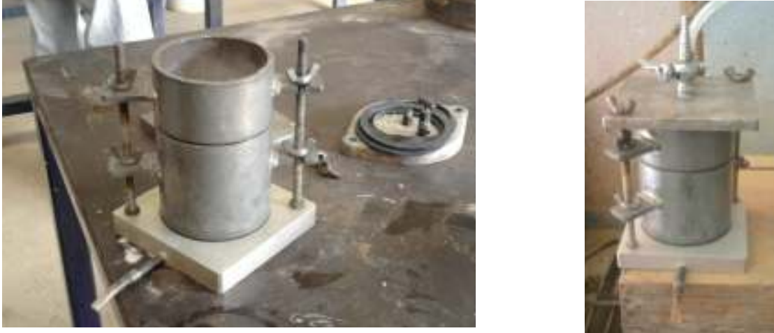
Figura 28. Montaje del equipo para el ensayo de permeabilidad
