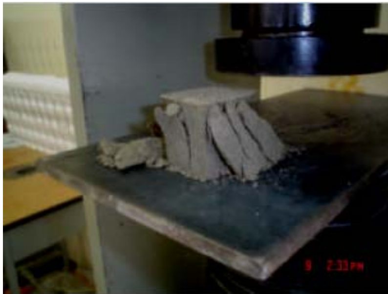
Figura 7. Ensayo a compresión
