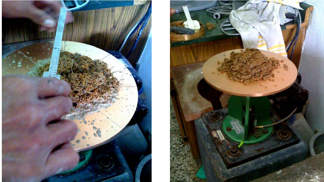
Figura 15. Ensayo de consistencia
