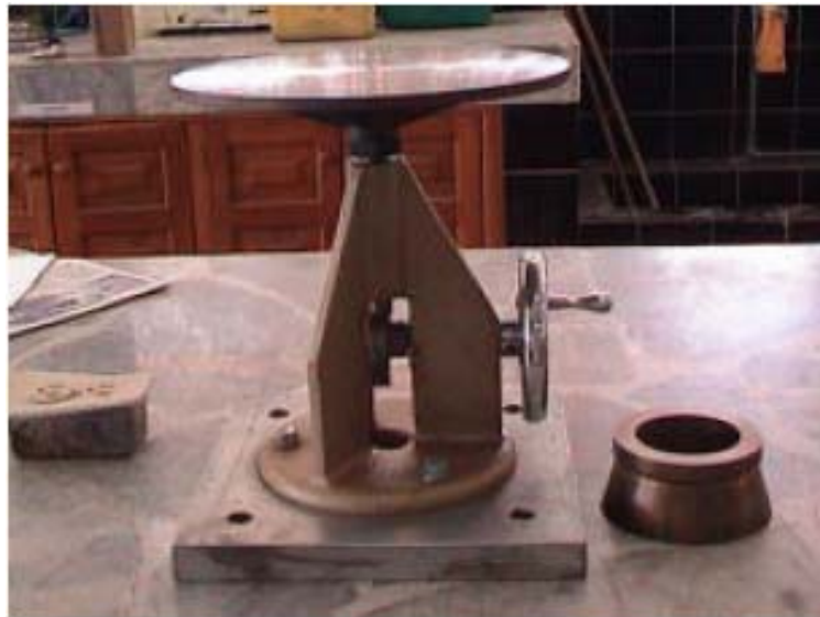
Figura 4. Equipo para ensayo de consistencia
