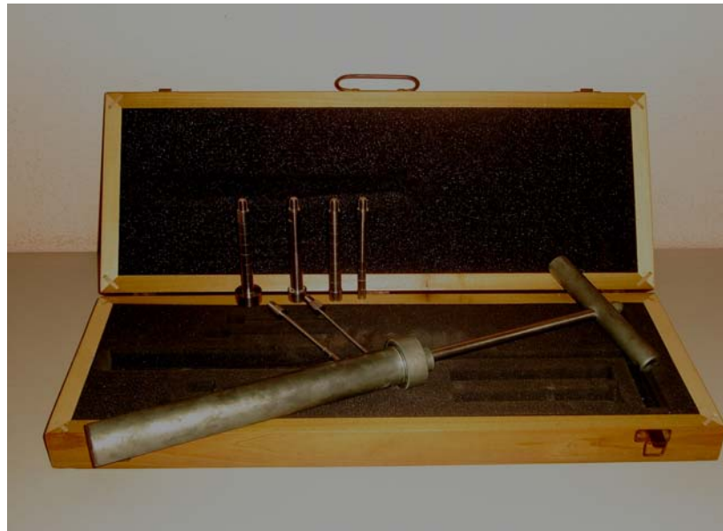
Figura 6. Equipo de ensayo para medir la velocidad de endurecimiento y resistencia a la penetración en morteros
