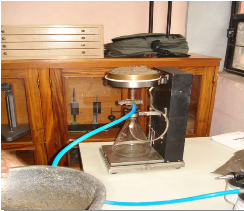
Figura 5. Equipo de ensayo para retención de agua en morteros
