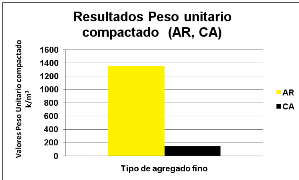
Figura 12. Peso unitario compactado, agregado fino
