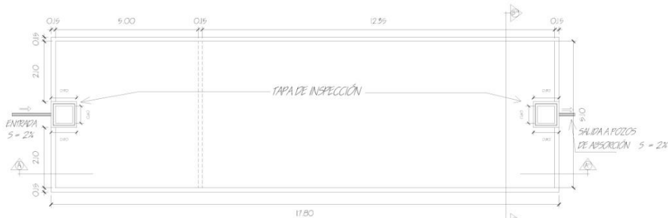
PLANTA POZO FOSA SÉPTICA
