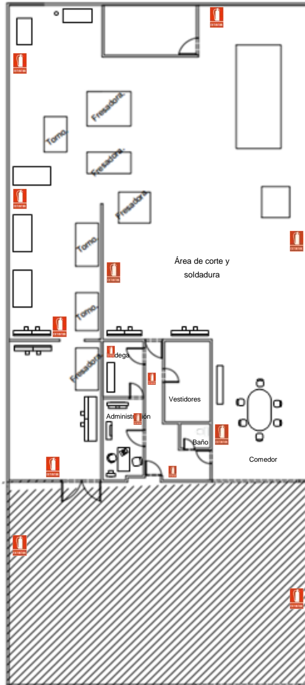
Figura 27. Distribución de extintores
