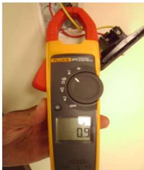
Figura 62. Medición de consumo en amperios (tubos Fluorescentes)
