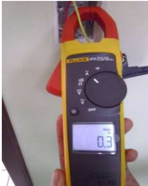
Figura 63. Medición de consumo en amperios (tubos LED)
