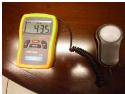
Figura 60. Nivel de iluminación (Lux) con tubos fluorescentes de 32W
