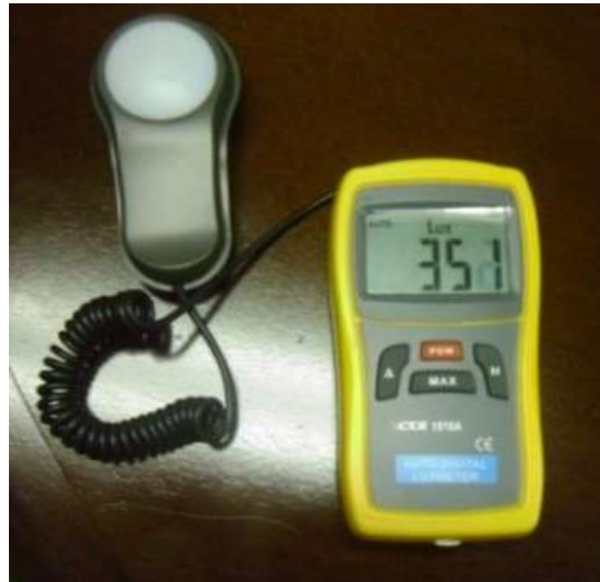
Figura 61. Nivel de iluminación (Lux) con tubos LED de 13W
