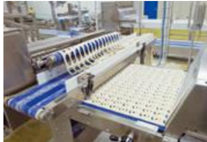
Figura 23. Retiro de masa residual (automatización)
