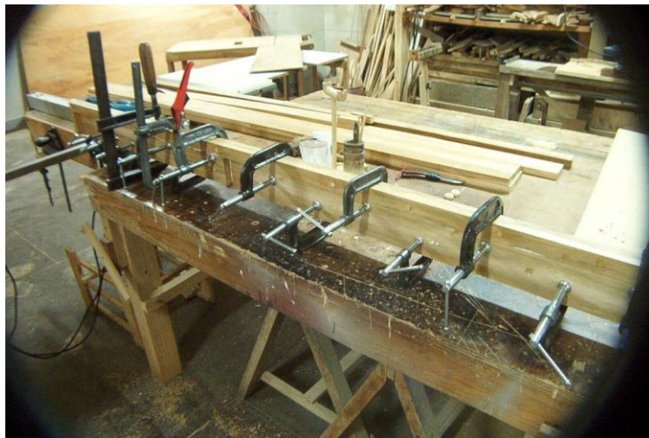
Vista del larguero secando en su primera fase, previo a colocar la tapadera
