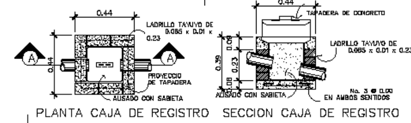
DETALLE CAJA DE REGISTRO S/E
