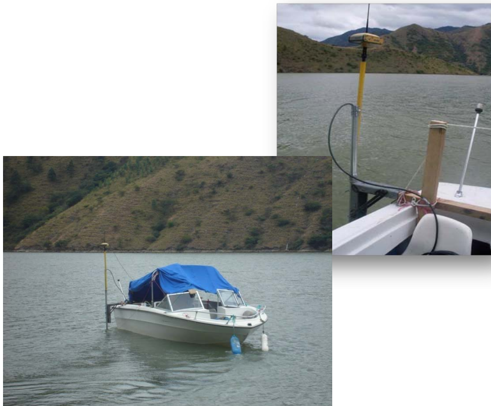
Figura 13. Gps de doble frecuencia instalados en lancha
