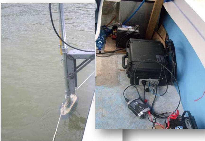
Figura 12. Ecosonda knudsen utilizado en la batimetría
