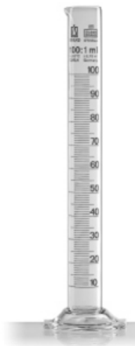
Figura 4. Probeta de polipropileno de 100 ml de capacidad
