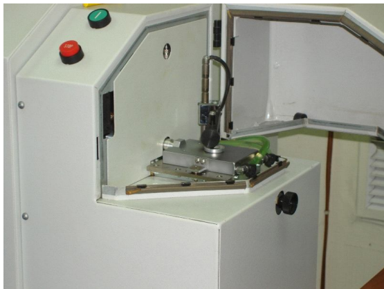
Figura 4. Espectrómetro de emisión óptica ARL 3460 B del laboratorio de SIDEGUA
