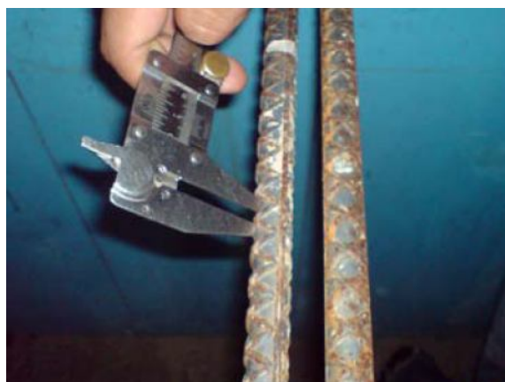
Figura 35. Medición de muestras con Vernier en laboratorio del CII
