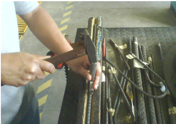
Figura 36. Marcaje de muestras para prueba de elongación en laboratorio del CII
