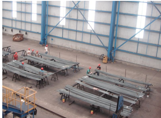
Figura 27. Proceso de empacado de SIDEGUA
