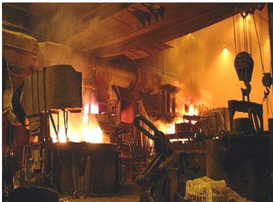
Figura 21. Horno de cucharón de fábrica de acero en Chicago, EUA
