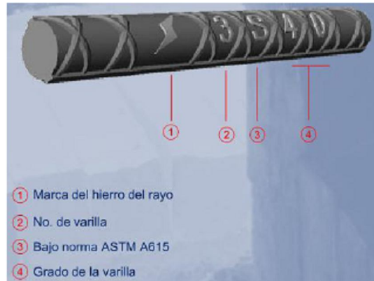
Figura 15. Marcaje según Aceros Suárez
