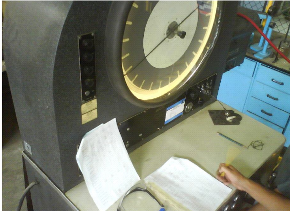
Figura 38. Escala para lectura de la Máquina Universal en ensayo de tensión, laboratorio del CII
