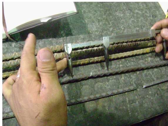
Figura 41. Lectura de la elongación al 20% con el extensómetro, luego de ensayo en laboratorio de CII
