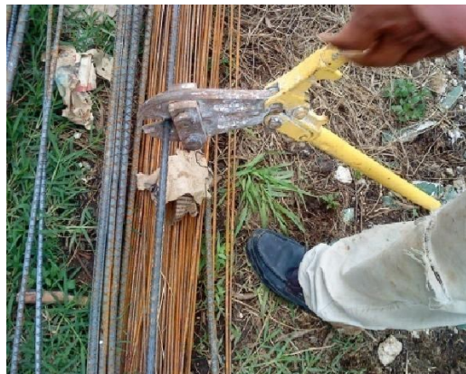
Figura 33. Corte de barras de acero para muestra en sitios de muestreo
