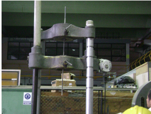
Figura 29. Máquina Universal del CII ensayando a tracción
