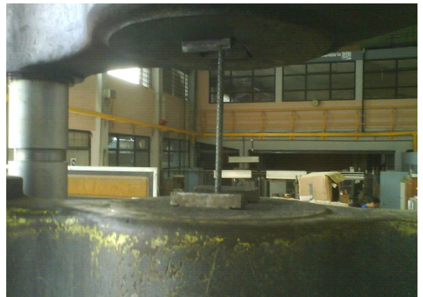
Figura 37. Ensayo de tensión de muestras en la Máquina Universal del laboratorio del CII
