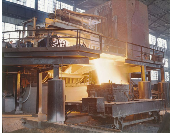
Figura 6. Horno de arco eléctrico de la acería Allegheny Ludlum, Pennsylvania, EUA
