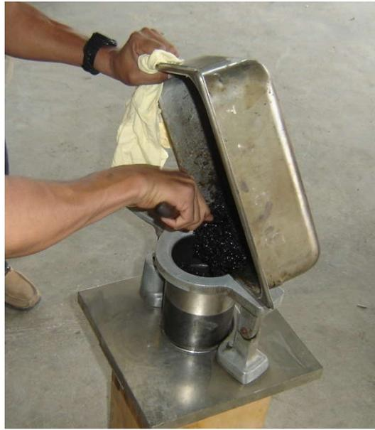
**Figura 13. Apisonamiento de la mezcla en el molde para elaboración de briqueta**
