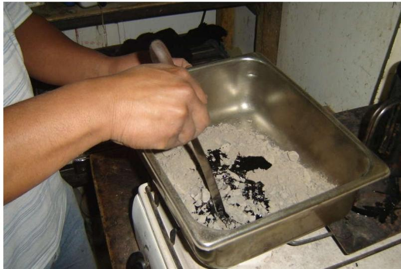
**Figura 11. Determinación de la temperatura durante mezclado**
