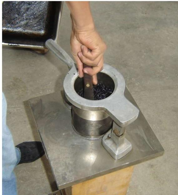
**Figura 14. Compactación de la mezcla con martillo**
