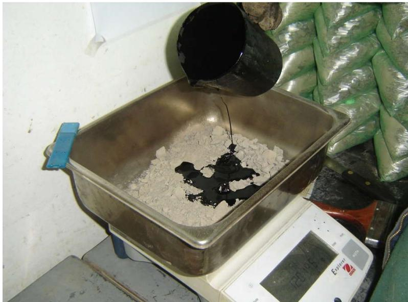
**Figura 10. Mezclado de asfalto y agregados para elaboración de briqueta**
