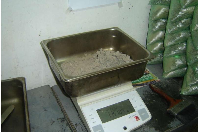
**Figura 9. Adición de asfalto por peso para elaboración de briqueta**
