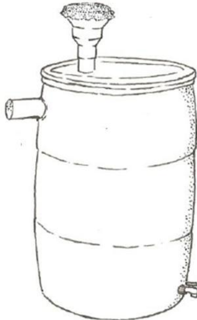
Figura 20. Interceptor de las primeras lluvias
