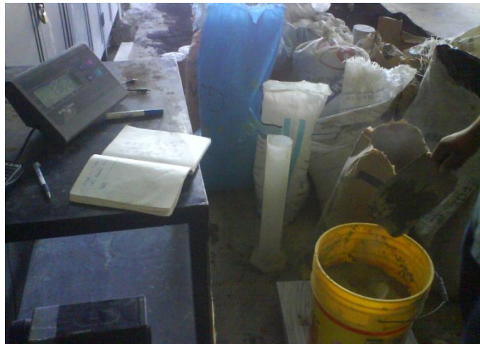
Figura 9: Pesado de los materiales para la mezcla, en la balanza electrónica
