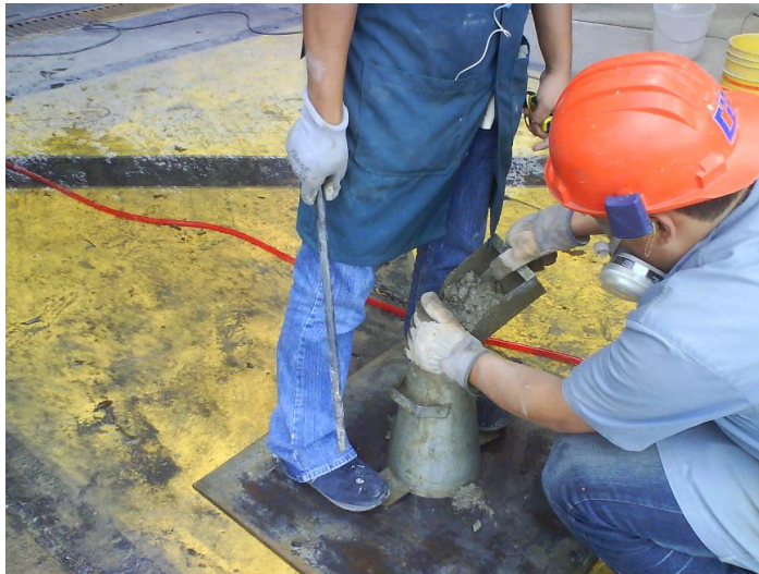
Figura 14: Ensayo de asentamiento, llenado del cono
