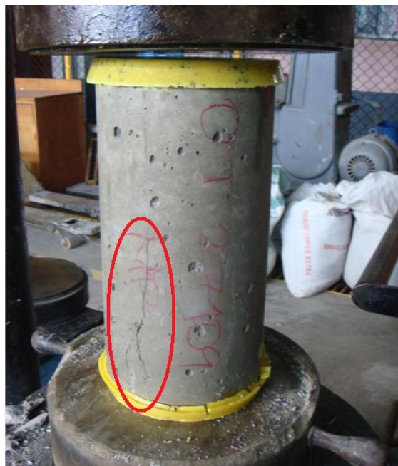
Figura 24: Falla en la Mezcla Patrón
