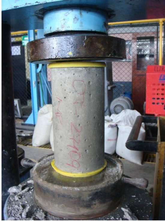
Figura 21: Realización del ensayo de compresión
