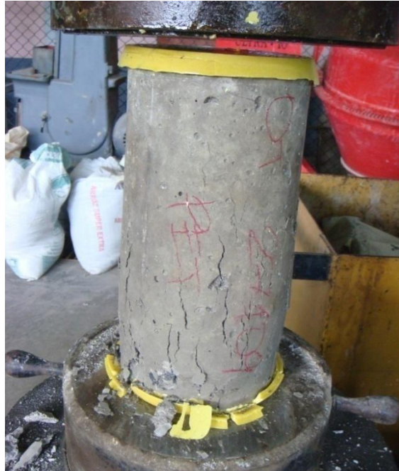
Figura 25: Falla en las mezclas con material de reciclaje
