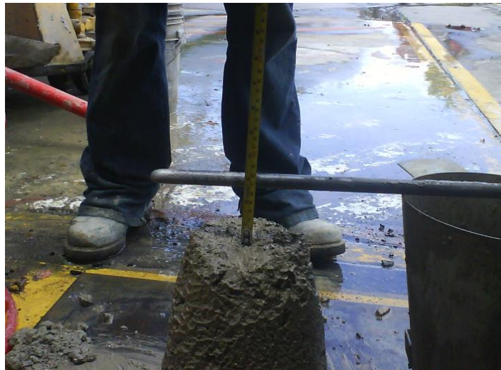
Figura 16: Ensayo de asentamiento, medición del asentamiento
