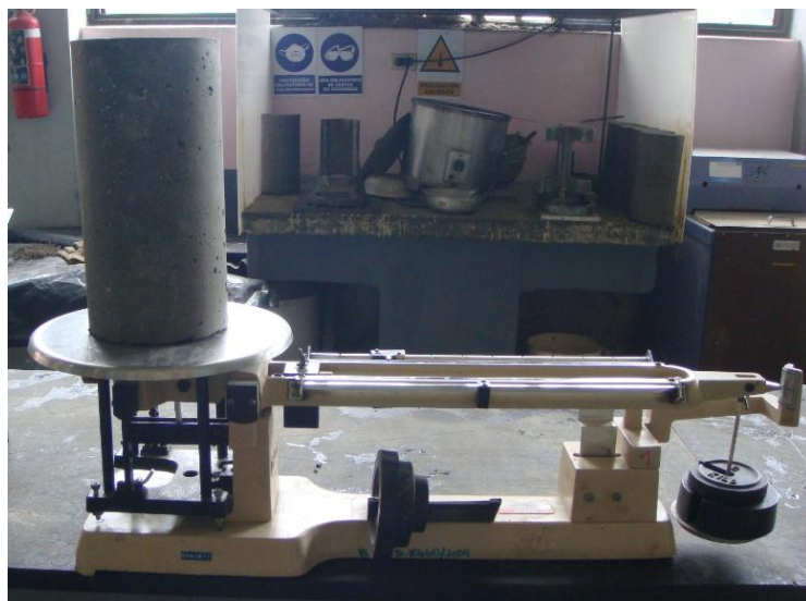
Figura 19: Pesado de las probetas
