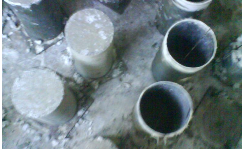
Figura 12: Desencofrado de Probetas
