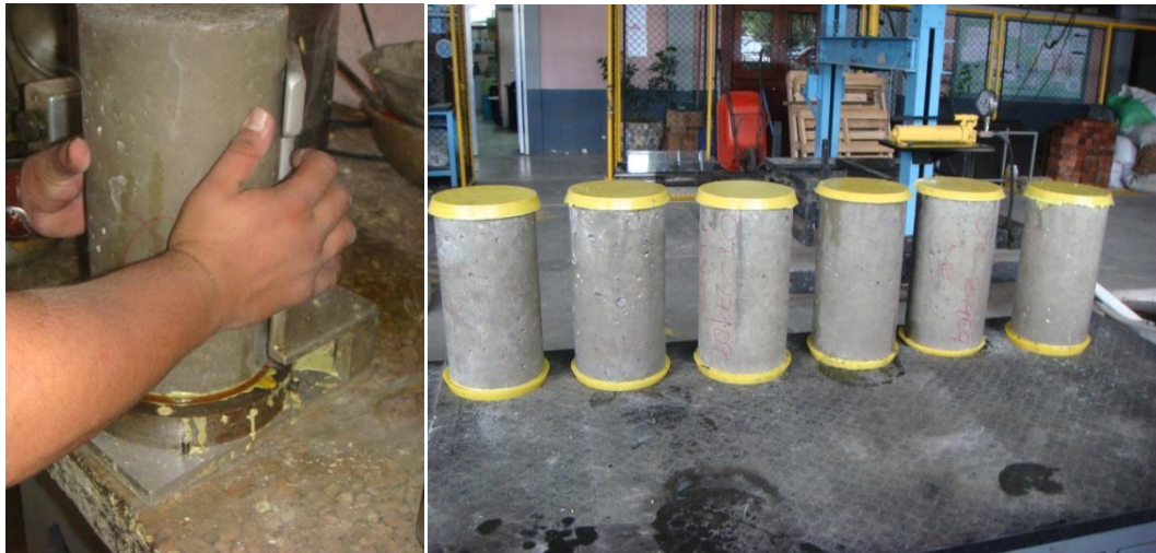
Figura 20: Nivelación de las Probetas con el azufre
