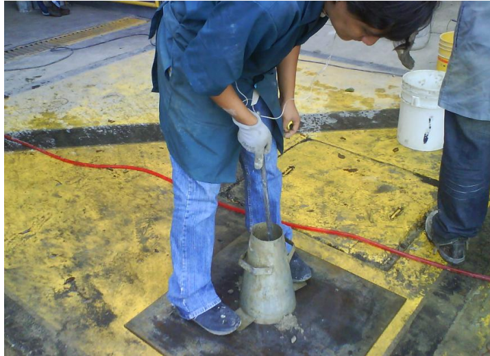
Figura 15: Ensayo de asentamiento, apisonado de la mezcla
