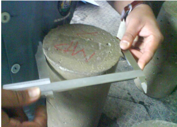
Figura 18: Medición de las probetas utilizando el Vernier
