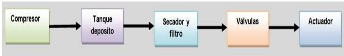
Figura 26. Secuencia de los sistemas neumáticos
