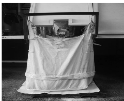
Figura 17. Dosificación de mezcla a saco tipo jumbo
