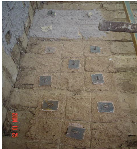
Figura 20. Placas con pegamento adheridas a la muestra para los ensayos respectivos
