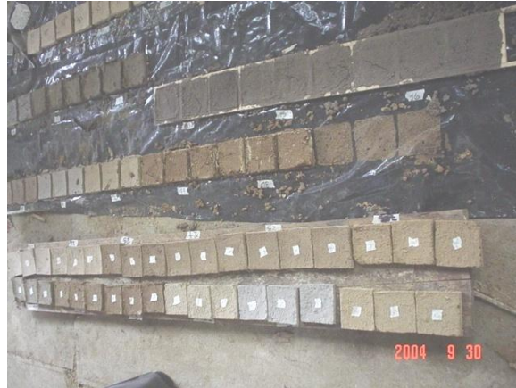
Figura 16. Elaboración de probetas para ensayo
