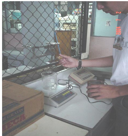
Figura 1. Preparación de la solución de hexametafosfato de sodio para el ensayo de granulometría por el método del hidrómetro
