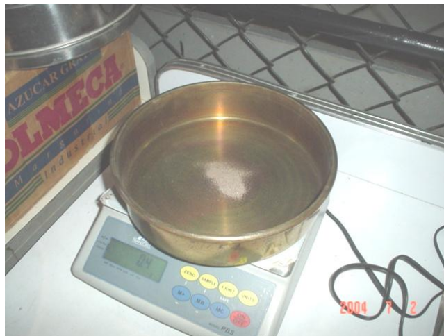
Figura 6. Tamizado y toma de peso del material para la tabulación de datos y obtención de resultados
