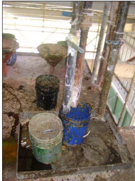
Figura 56. Área no señalizada, área de manejo de químicos
