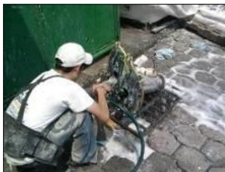
Figura 10. Lavado de reductor
