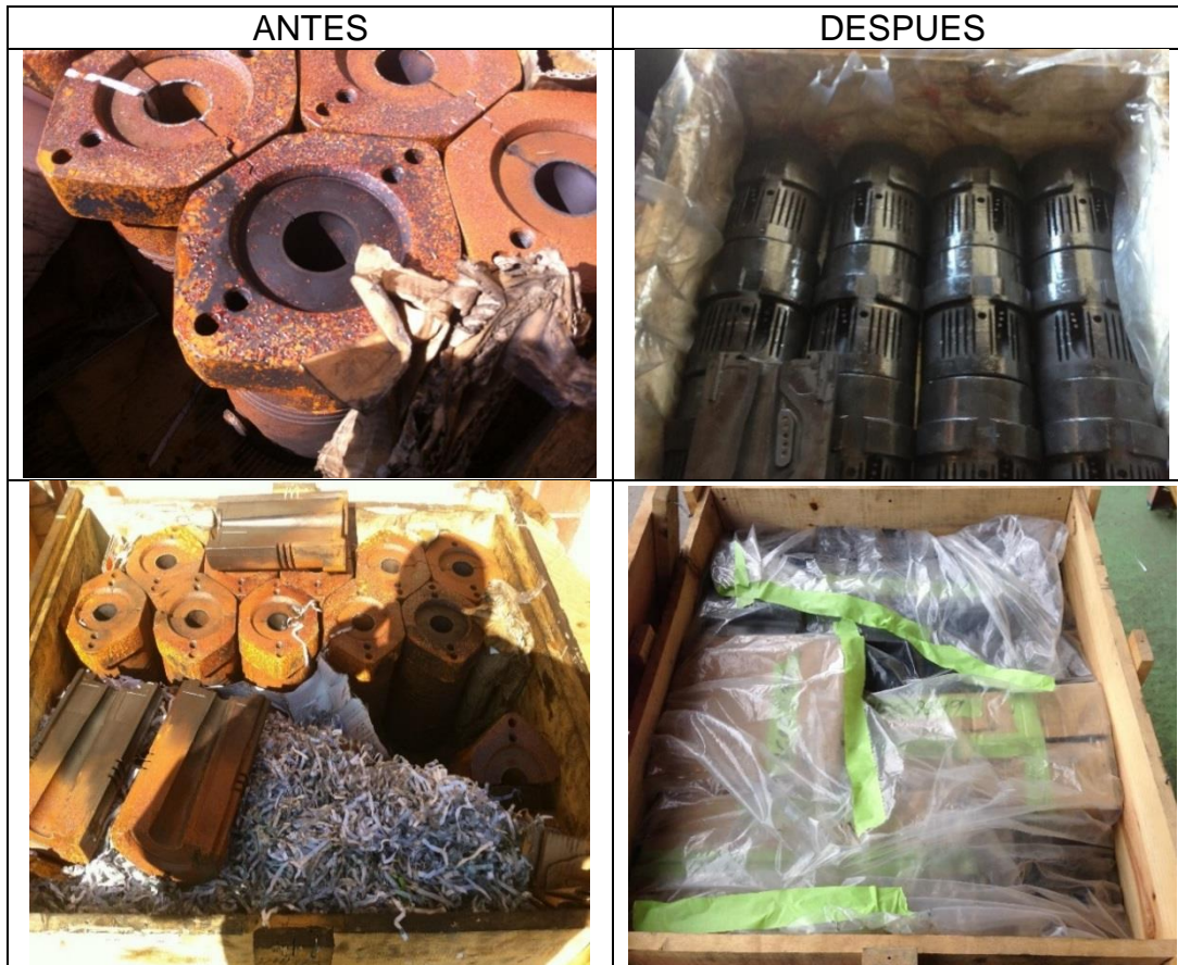
Figura 27. Comparación de la lubricación y empaque de la moldura
