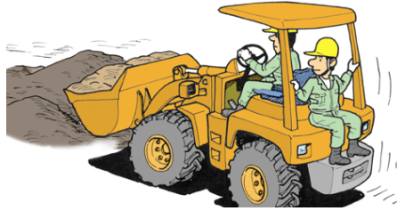
Figura 39. El trabajador utiliza la maquinaria pesada como medio de transporte
