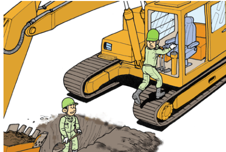
Figura 38. Trabajador dentro del área de trabajo de maquinaria pesada
