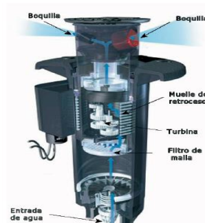
Figura 54. Aspersor de turbina
