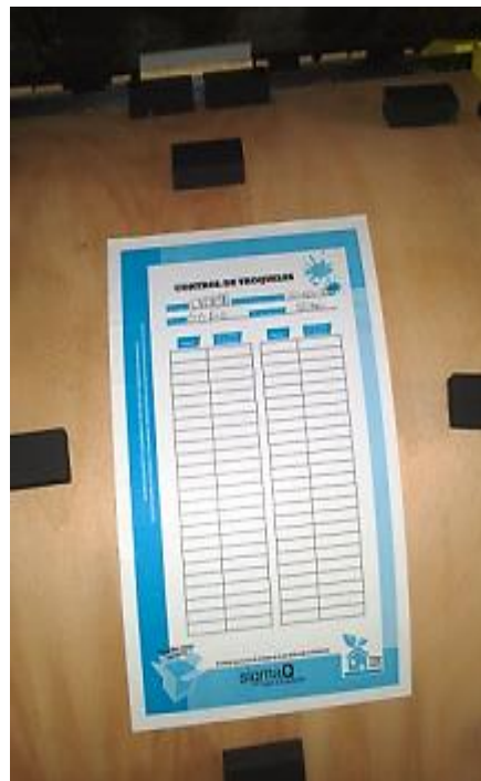
Figura 28. Colocación de boleta de control en troquel
