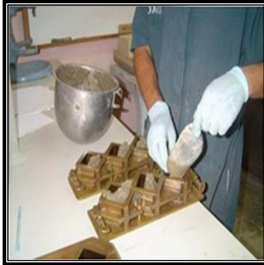
Figura 22. Prismas para testigos de mortero
