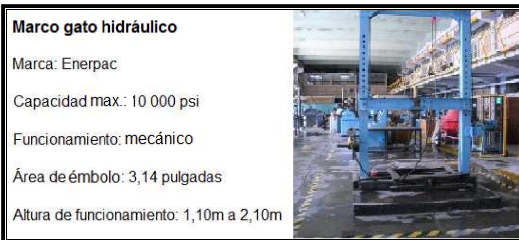
Figura 9. Marco gato hidráulico
