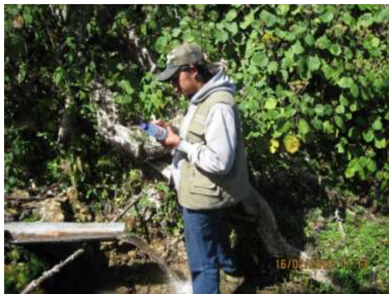
Figura 5. Toma de muestra para el análisis de calidad de agua
