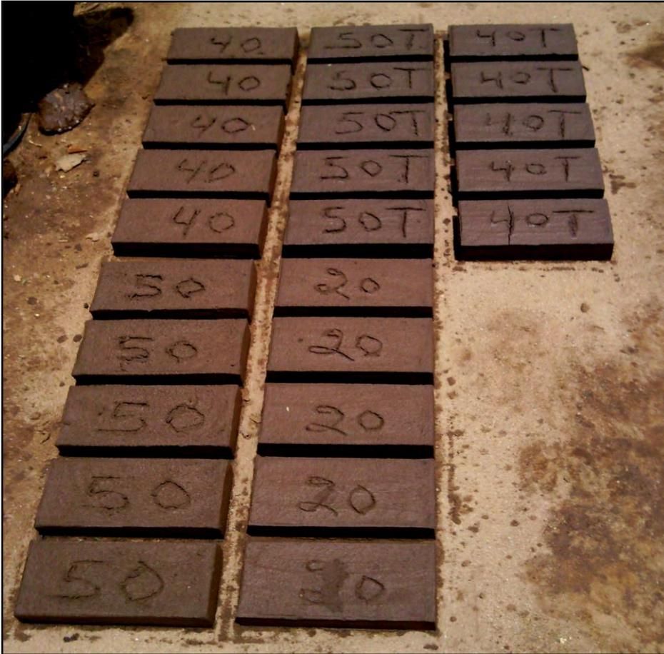
Fuente: ladrillos fabricados bajo proporciones, ladrillera La Española, en el centro de El tejar, Chimaltenango
