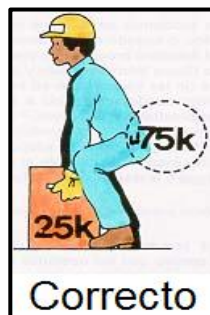
Figura 24. Correcto levantamiento de cargas pesadas
