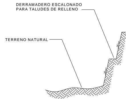
SECCIÓN LONGITUDINAL DE DERRAMADEROS SIN ESCALA
