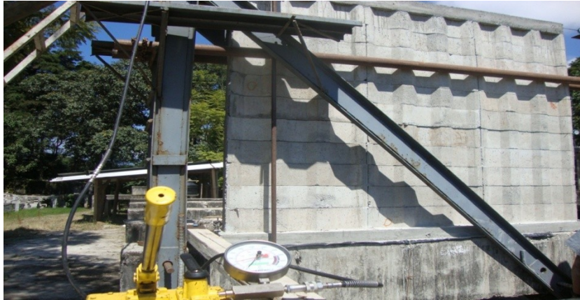
Figura 36. Equipo hidráulico para realizar ensayo a corte
