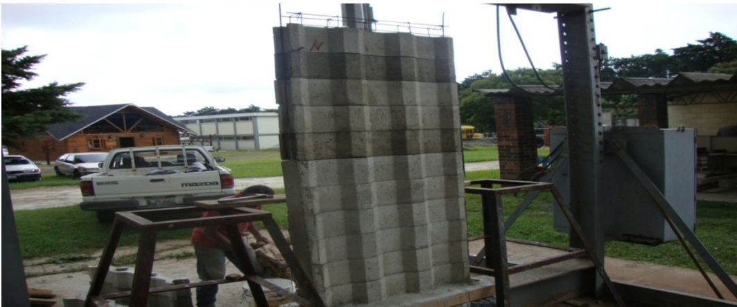
Figura 42. Ensayo a compresión del muro tipo llave sin refuerzo
