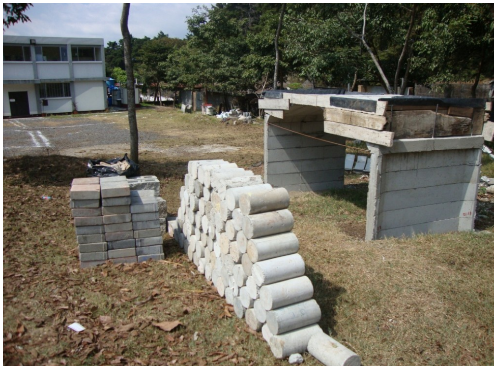
Figura 46. Ensayo de carga distribuida y lateral a sistema muro-losa con placa tipo llave reforzada
