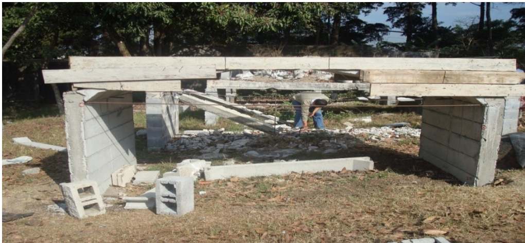
Figura 47. Colocación de madera y deformómetros
