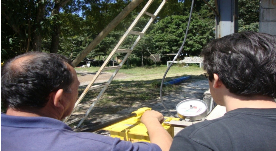
Figura 39. Aplicación de carga al muro
