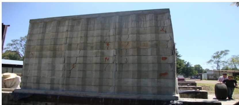
Figura 41. Vista posterior del muro tipo llave sin refuerzo ensayado
