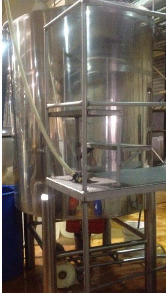
Figura 4. Tanque de capacidad de 2 000 litros
