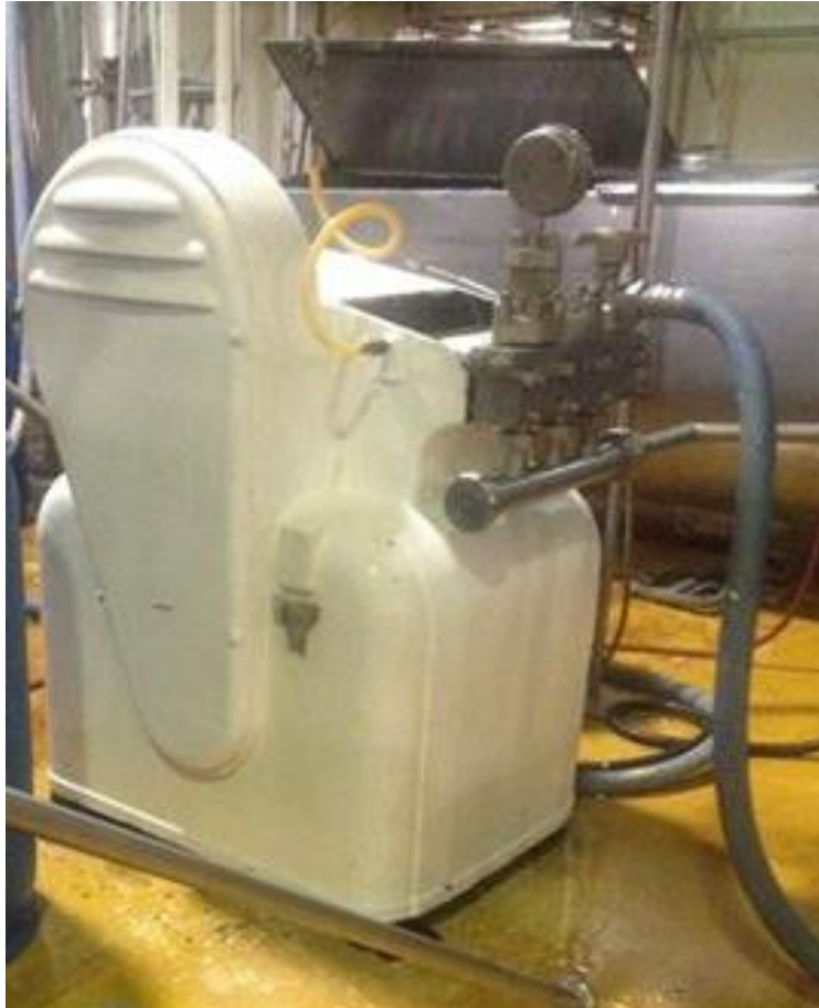
Figura 8. Homogeneizador de capacidad de 20 hp
