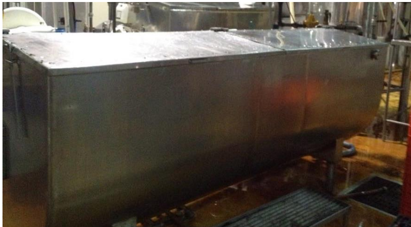
Figura 2. Tanque mezclador de 2 000 litros de capacidad
