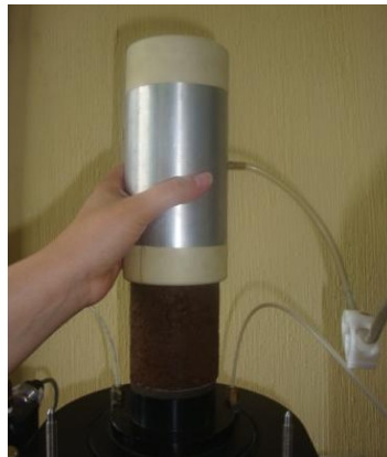
Figura 35. Colocación de membrana de látex
