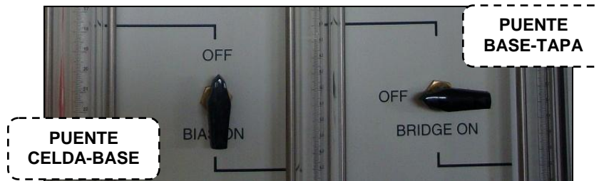
Figura 32. Puentes de presión entre celda-base y base-tapa
