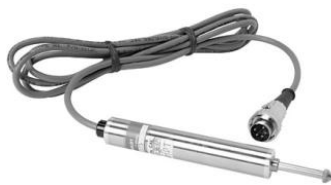
Figura 10. Transductor de deformación vertical
