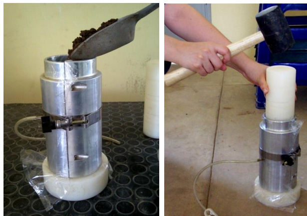
Figura 22. Compactación del espécimen
