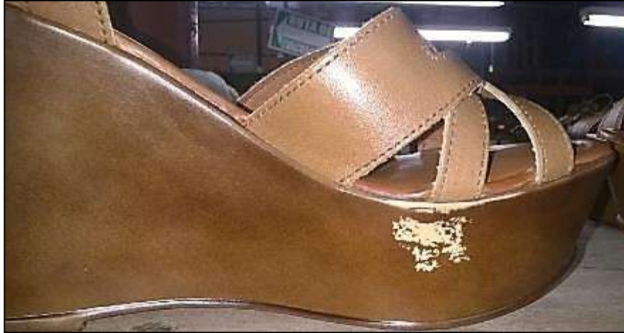
Figura 39. Suela dañada en el proceso
