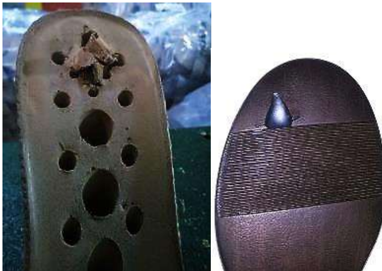
Figura 23. Residuos de inyectado o mal inyectado
