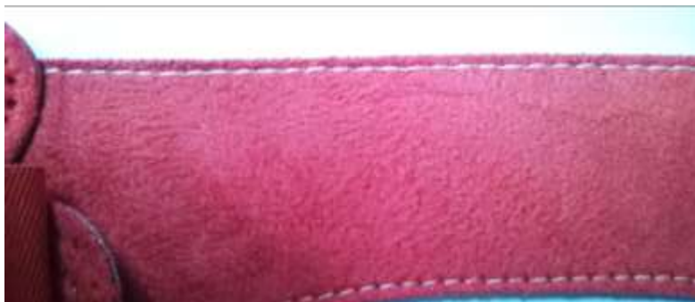
Figura 35. Ilustración de una puntada con problemas de tensión
