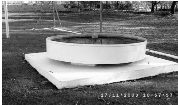
Figura 10. Tanque de evaporación
