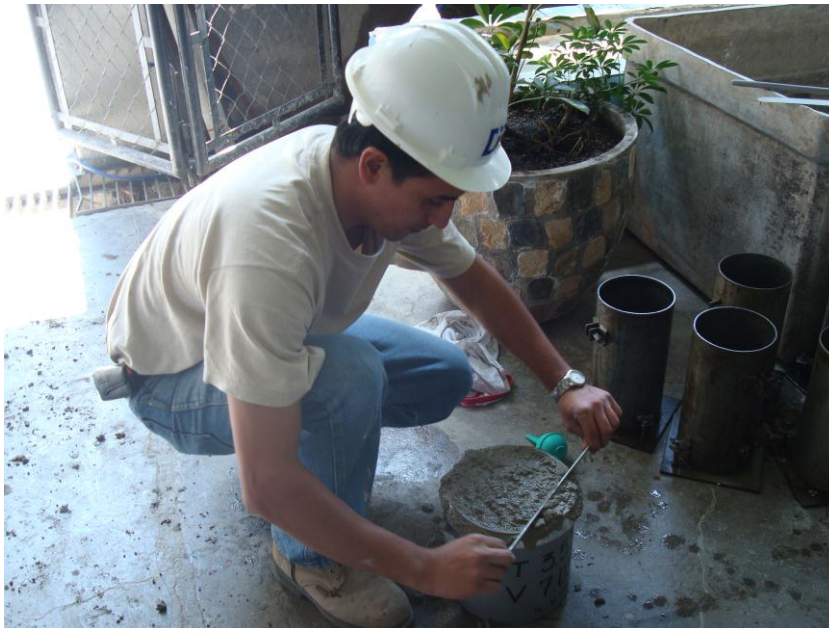
Figura 10. Realización de peso unitario
