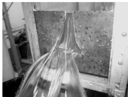
Figura 93. Vertedero en funcionamiento
