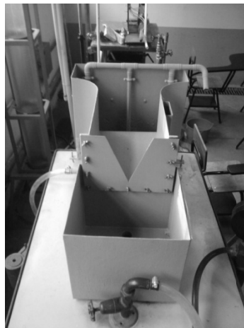
Figura 74. Depósito utilizado para aforo volumétrico
