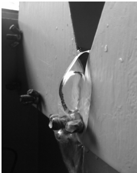
Figura 72. Zona aireada bajo la lámina vertiente
