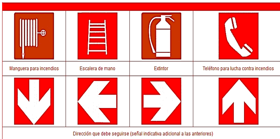
Figura 18. Señales contra incendio
