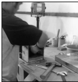
Figura 96. Proceso de desmontaje de molde
