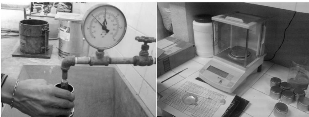
Tamiz # 325 colocado debajo de manómetro a una presión de 10 psi
