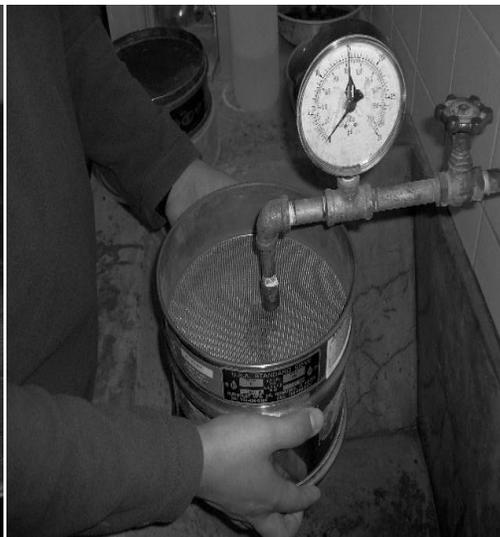
Colocación de tamices debajo de manómetro utilizado para el ensayo
