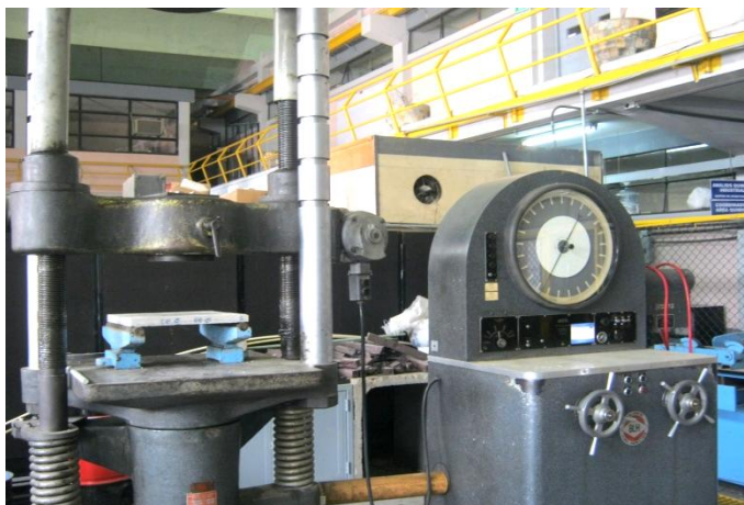
Figura 27. Máquina Universal para prueba de flexión y adherencia
